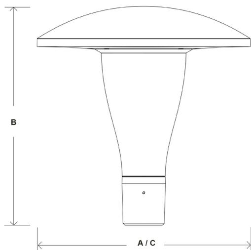
PILZEO | PILZEO bietet eine Mastaufsatzmontage auf einem Mast mit Zopf  $\text{\O}60$  mm durch Anziehen von 2XM8-Schraube
