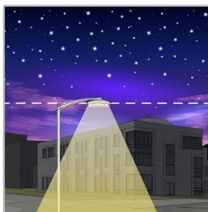
Der ULR-Wert (Upward Light Ratio) und der ULOR-Wert (Upward Light Output Ratio) geben an, welcher Anteil des Lichts Richtung Himmel abgestrahlt wird. Beim ULOR-Wert wird zusätzlich der Lichtstrom der Leuchte berücksichtigt. Bei diesen Leuchtenmodellen von Schröder wird der nach oben gerichtete Lichtstrom minimiert bzw. komplett ausgeschaltet (je nach den verwendeten Optionen). Sie entsprechen strengen internationalen
