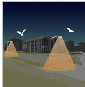
bevorzugt auf warmweiße LEDs mit minimalem Blauanteil in Verbindung mit innovativen, mit Sensoren bestückten Steuerungssystemen. Auf diese Weise kann die Beleuchtung stets an den jeweils tatsächlich erforderlichen Bedarf angepasst werden, sodass die Auswirkungen auf die Tier- und Pflanzenwelt minimiert werden.
