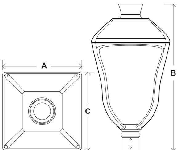
STYLAGE | Mastaufsatz für Mastzopf Ø60 mm
