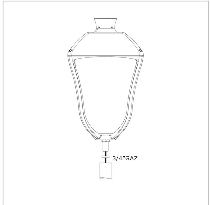
STYLAGE | Abgehängte Version (mit 1" Gewinde oder 3/4" Gewinde)
