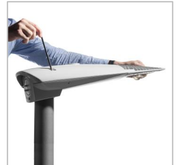
Universelle Halterung für seitliche oder Mastaufsatzmontage mit einstellbarer Neigung in Schritten von 2,5°.
